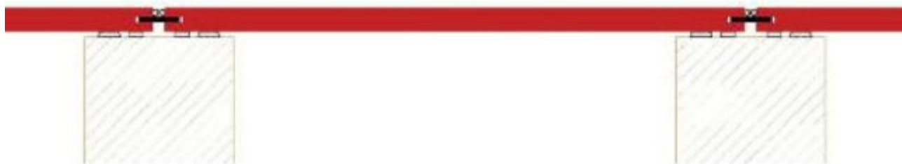
Płyta balkonowa mocowana niewidocznie (system klejony) do dźwigarów drewnianych
