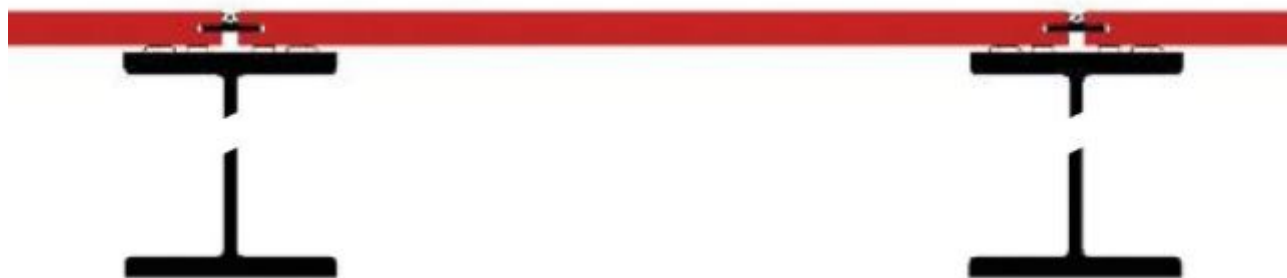
Płyta balkonowa mocowana niewidocznie (system klejony) do dźwigarów stalowych
