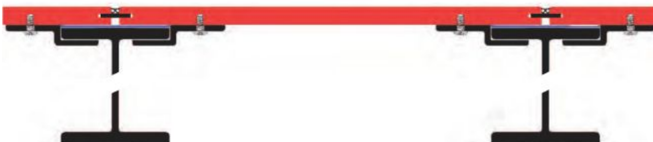
Płyta balkonowa mocowana mechanicznie niewidocznie (śruby) do dźwigarów stalowych
