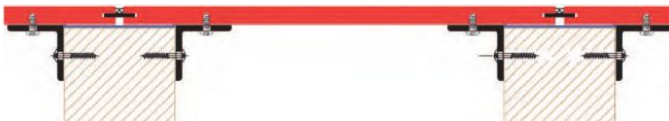
Płyta balkonowa mocowana mechanicznie niewidocznie (śruby) do dźwigarów drewnianych
